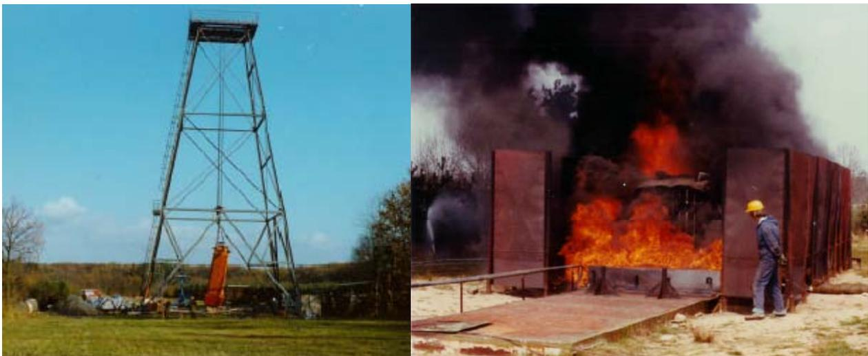
Abbildung G-2: Fallversuch eines Transport- und Lagerbehälters für abgebrannte Brennelemente im neuen Versuchsstand der Bundesanstalt für Materialprüfung (BAM) im Jahr 2004 (copyright: BAM)
