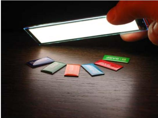
**Leuchtdioden**) eine nahezu zweifach höhere Effizienz im Energieverbrauch gegenüber konventionellen Leuchtstoffen bei gleicher Lebensdauer prognostiziert. Solche Beleuchtungssysteme werden innerhalb der nächsten Jahre und Dekaden traditionelle Lampensysteme teilweise ersetzen und vollkommen neue Anwendungen erschließen. Neben der Erzeugung flächigen Lichtes, was deutlich angenehmer für den Nutzer ist, sind sie wesentlich einfacher zu recyceln, da sie -
