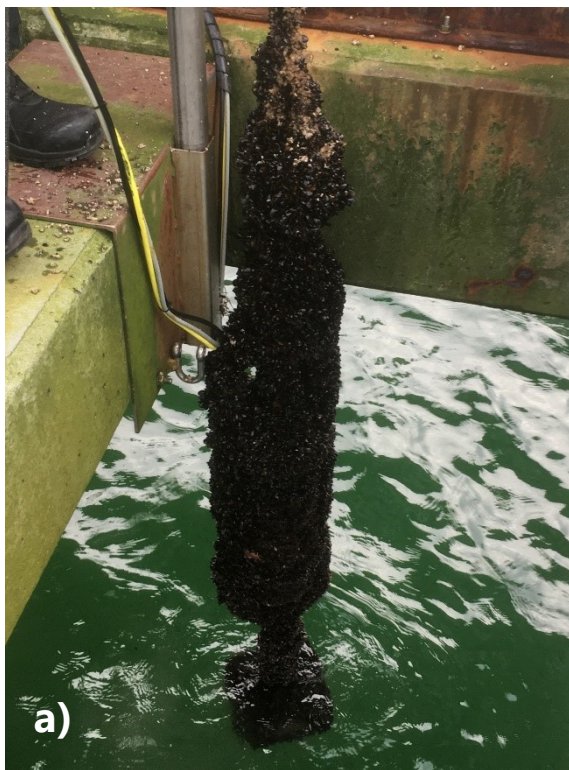
Abb. 2: Sonde nach der Sommersaison a) ohne Antifoulinganstrich und ohne Nylonstrumpf bzw. b) mit Antifoulinganstrich und mit Nylonstrumpf
