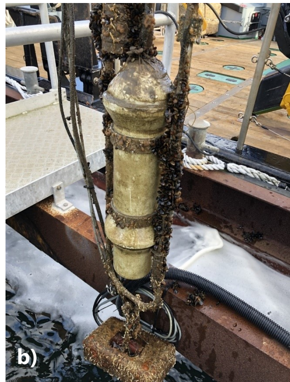
Abb. 2: Sonde nach der Sommersaison a) ohne Antifoulinganstrich und ohne Nylonstrumpf bzw. b) mit Antifoulinganstrich und mit Nylonstrumpf
