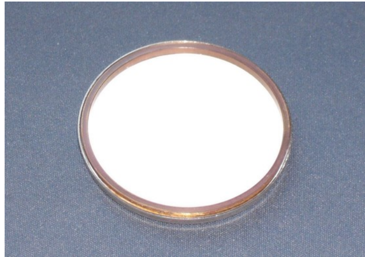
Abb. 3: Mit einem Haltering in der Messschale fixierter Filterkuchen.
