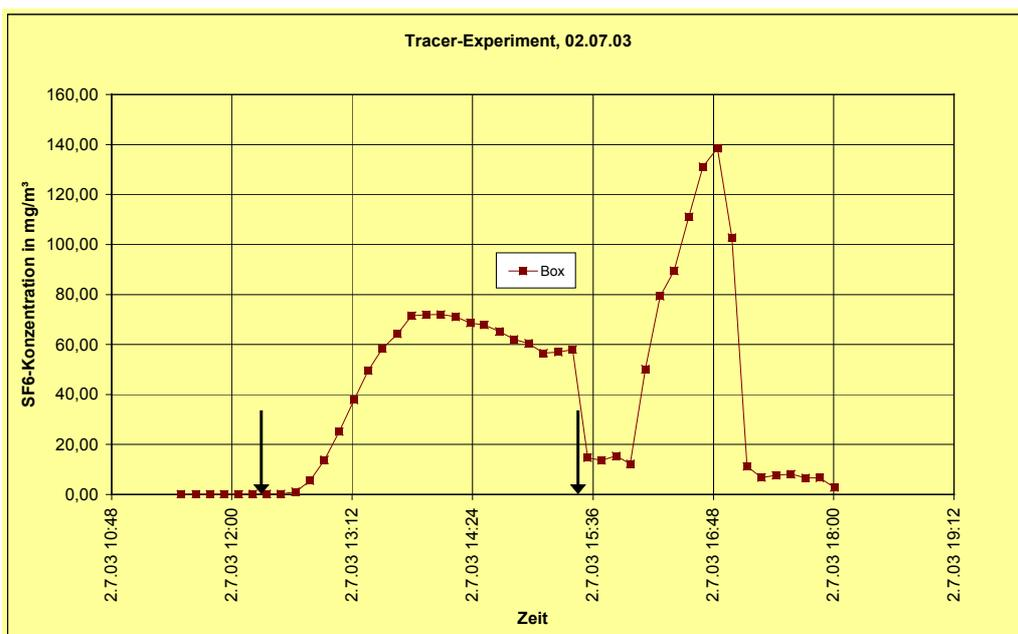
Abbildung 132: Zeitabhängigkeit der Tracergaskonzentration in der Box auf der Abdeckung
