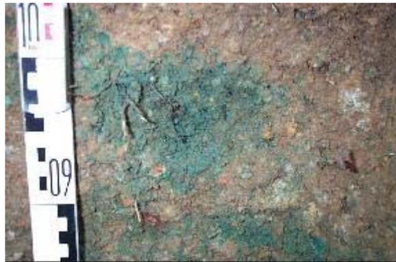
Abbildung 94: Aufschluss V2/A1 auf der IAA Dänkritz, deutlich erkennbare Färbung des Abdeckmaterials durch Tracerflüssigkeit im Bereich von Wurzeln
