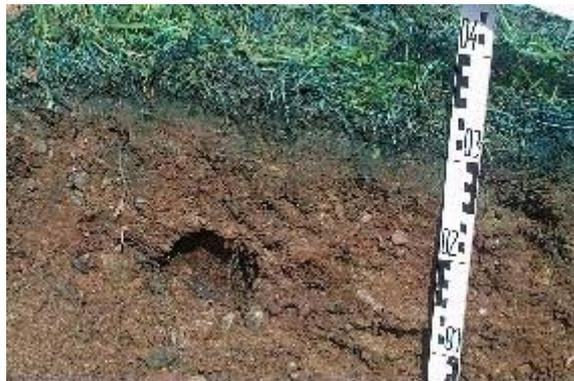
Abbildung 102: Aufschluss V7/A2 auf der Halde B, gleichmäßige Versickerung bis in 0,05 m Tiefe, vereinzelt bis in max. 0,20 m Tiefe vor allem entlang
