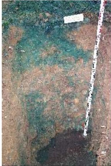
Abbildung 103: Aufschluss V2/A2 auf der IAA Dänkriz, deutlich erkennbare präferentielle Sickerwege in der Abdeckung, max. Sickerweg > 1 m, Sickerzeit 24 h
