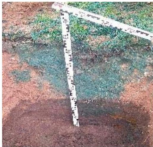
Abbildung 62: Fließmuster der Tracerflüssigkeit im zu den Aufschlüssen Sch23 und Sch24 benachbarten Aufschluss V9
