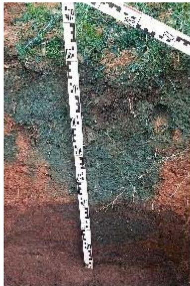
Abbildung 104: Aufschluss V9/A2 auf der Nordhalde Lengenfeld, maximaler Sickerweg ca. 0,7 m, Sickerzeit 27 h, vergleichsweise gleichmäßige Versickerung der Tracerflüssigkeit im stark durchwurzelten Bereich der Abdeckung und entlang von Wurzeln bis in das Tailingsmaterial
