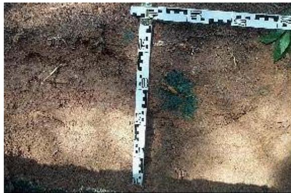
Abbildung 111: Detailansicht gemäß Abbildung 110, erkundete Färbung des Bodens durch Tracerflüssigkeit im Bereich einer Starkwurzel außerhalb der Versickerungsfläche
