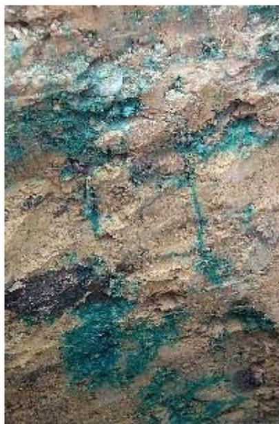
Abbildung 99: Detailansicht aus Aufschluss V5/A2 auf dem Collmberg, Färbung des Bodens mit Tracerflüssigkeit im Bereich von Regenwurmgingen in ca. 0,5 m Tiefe
