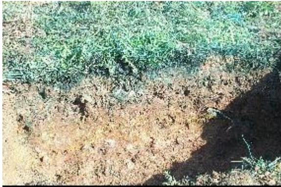
Abbildung 101: Aufschluss V6/A2 auf der Halde B, gleichmäßige Versickerung bis in 0,05 m Tiefe, vereinzelt bis in max. 0,15 m Tiefe entlang von Klee-
