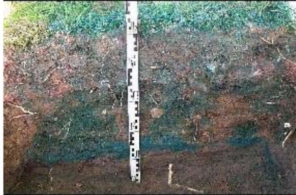
Abbildung 106: Aufschluss V10/A1 auf dem Collmberg, maximale Versickerungstiefe der Tracerflüssigkeit 0,40 m, deutlich erkennbar ist das vergleichsweise einheitliche Vordringen der Versickerungsfront und ihr Ende im Bereich des Schichtwechsels zwischen locker gelagerten Abdeckschichten und dicht gelagerter Abdeckschicht (Feinsand)
