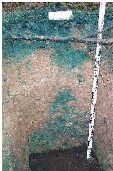
Abbildung 91: Aufschluss V2/A3 auf der IAA Dänkriz, deutlich erkennbare präferentielle Fließwege, maximaler Sickerweg in 24 h > 1 m
