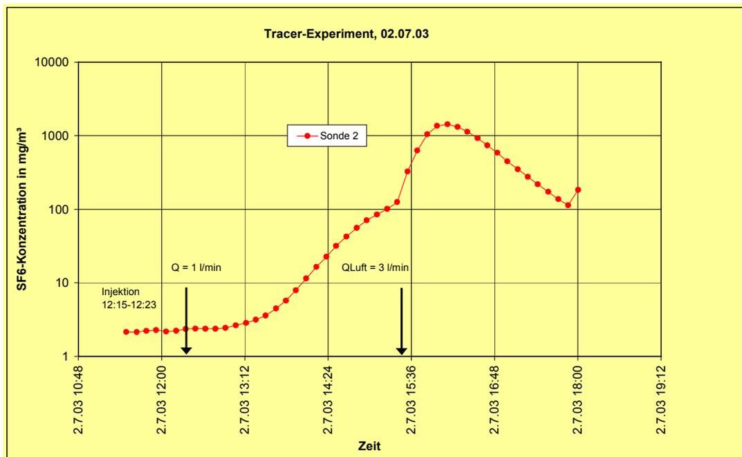
Abbildung 130: Tracergasausbreitung bis zur Messstelle 2 in 0,75 m Tiefe in der Abdeckung
