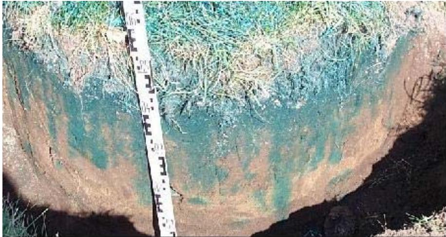
Abbildung 92: Aufschluss V1 auf der Wiese in Rochwitz, deutlich erkennbare präferentielle Fließwege, maximaler Sickerweg in 2,5 h ca. 0,5 m
