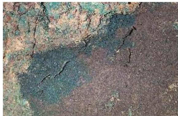
Abbildung 95: Aufschluss V2/A2 auf der IAA Dänkritz, deutlich erkennbare Färbung des Abdeckmaterials durch Tracerflüssigkeit im Bereich von Wurzeln, die Tracerflüssigkeit ist entlang von Wurzeln innerhalb von 24 h durch das Abdeckmaterial (ca. 1 m mächtig) bis in die Tailings versickert
