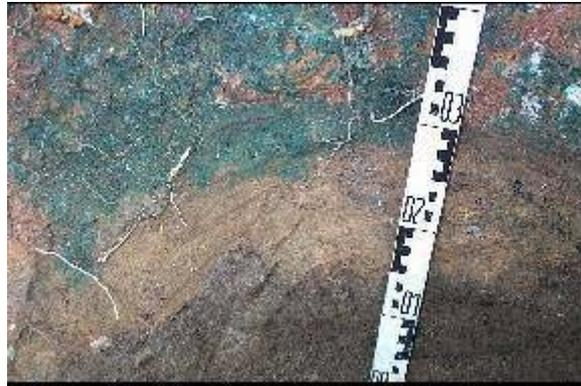
Abbildung 108: Detailansicht des Aufschlusses V11/A3 auf dem Collmberg, deutlich erkennbar die Grenze der Sickerfront der Tracerflüssigkeit am Schichtwechsel zwischen vergleichsweise locker und vergleichsweise dicht gelagerten Schichten
