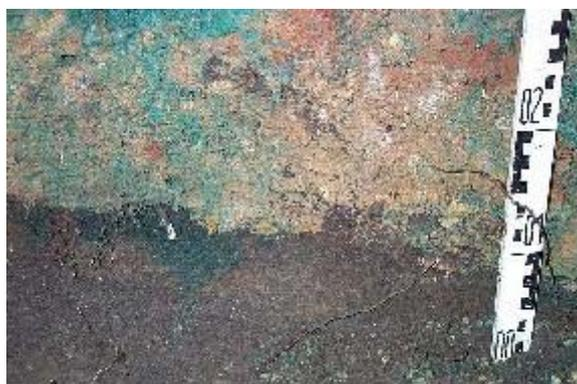
Abbildung 97: Detailansicht aus Aufschluss V2/A4 auf der IAA Dänkriz, deutlich erkennbare Färbung des Abdeckmaterials durch Tracerflüssigkeit im Bereich von Wurzeln, die Tracerflüssigkeit ist entlang von Wurzeln innerhalb von 24 h durch das Abdeckmaterial (ca. 1 m mächtig) bis in die Tailings versickert.
