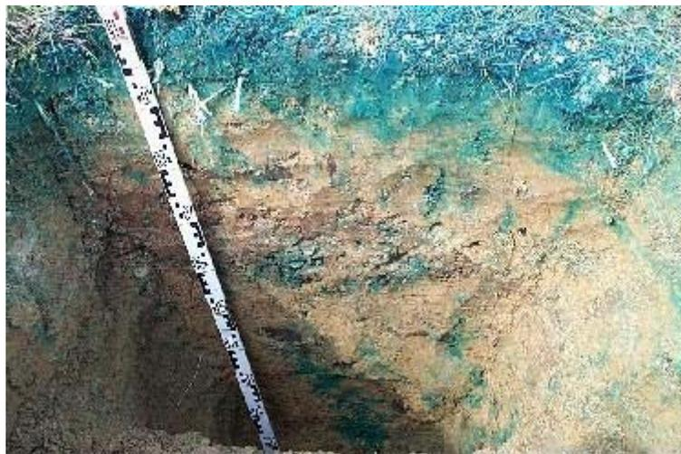
Abbildung 93: Aufschluss V5/A3 auf dem Collmberg, deutlich erkennbare präferentielle Fließwege, maximaler Sickerweg in 22 h ca. 1 m
