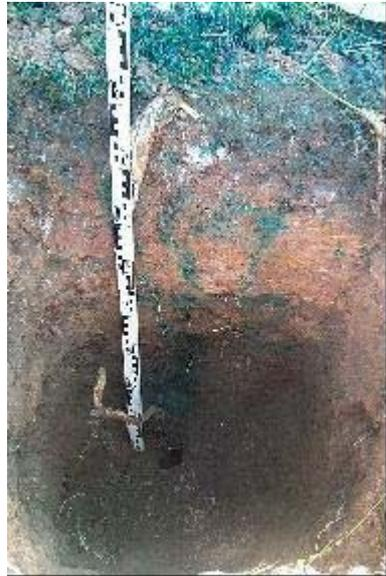
Abbildung 105: Aufschluss V11/A1 auf dem Collmberg, deutlich erkennbare präferentielle Sickerwege in der Abdeckung, max. Sickerweg > 0,8 m, Sickerzeit 26 h
