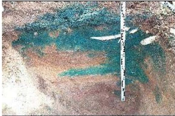
Abbildung 112: Aufschluss V8/A4 auf der Nordhalde, maximale Versickerungstiefe der Tracerflüssigkeit 0,70 m, vor allem im stärker durchwurzelten Bereich bis 0,20 m Tiefe eine vergleichsweise gleichmäßige Versickerung der Tracerflüssigkeit erkennbar, in 0,40 m Tiefe Erkundung einer vergleichsweise locker gelagerten mittelsandigen Schicht in der sich die Tracerflüssigkeit horizontal verteilt hat.
