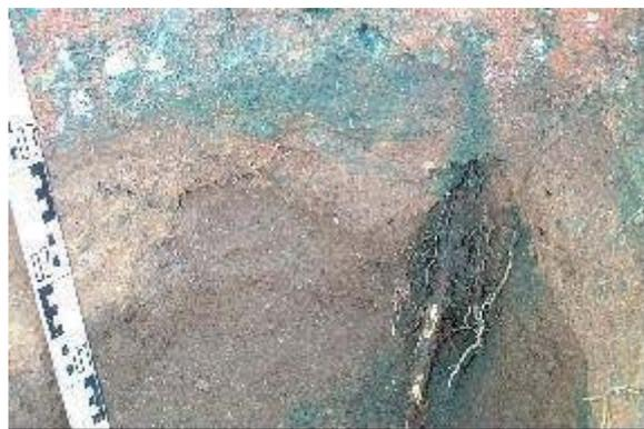
Abbildung 109: Detailansicht des Aufschlusses V11/A3 auf dem Collmberg, deutlich erkennbare Färbung des dicht gelagerten Abdeckmaterials nur im Wurzelbereich
