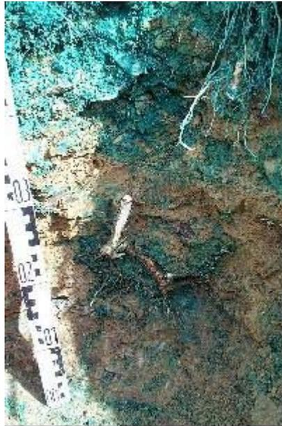
Abbildung 98: Detailansicht aus Aufschluss V4/A3 auf dem Collmberg, deutlich erkennbare Färbung des Abdeckmaterials durch Tracerflüssigkeit im Bereich von Wurzeln
