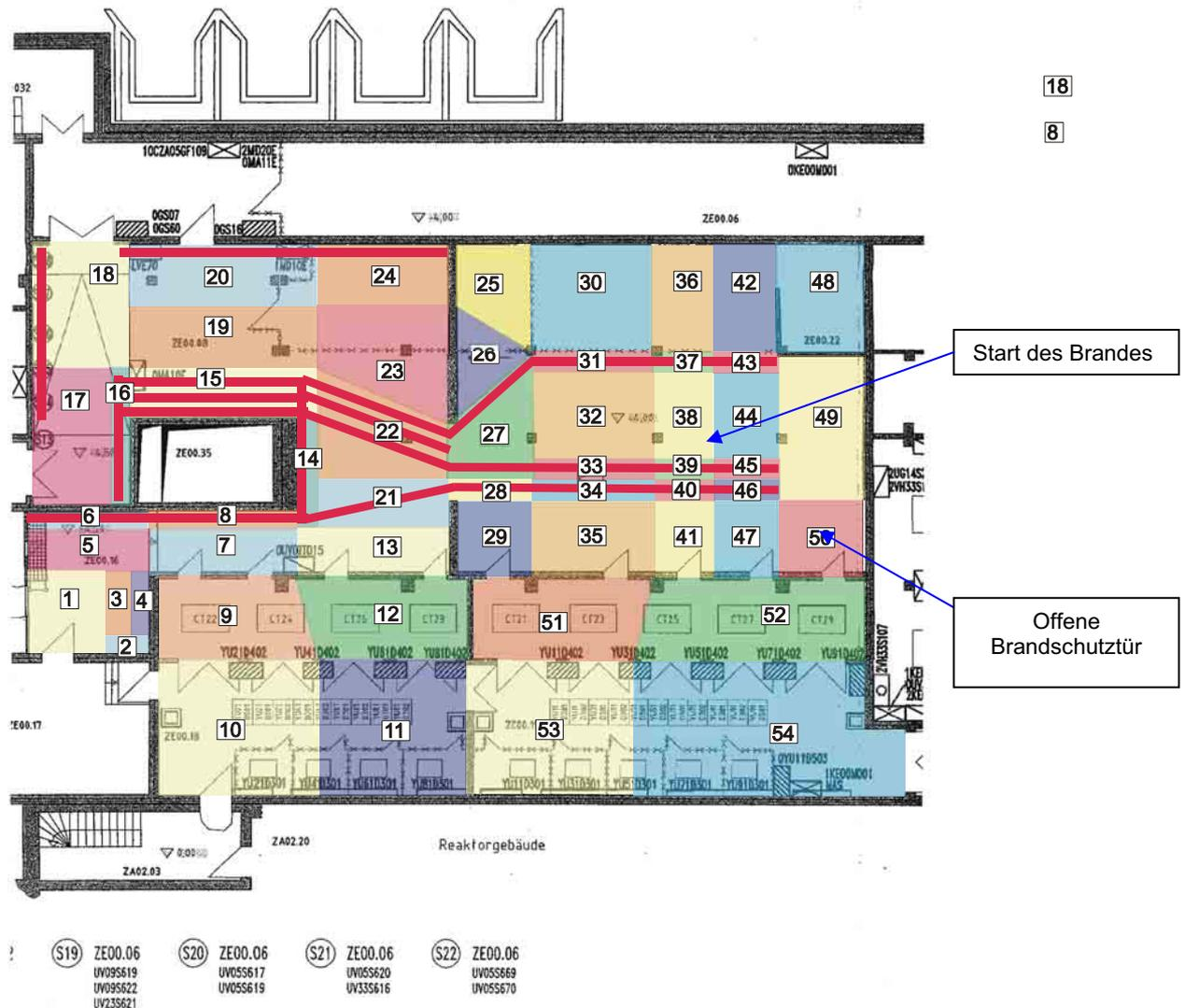
**Abb. 3-4:** Nodalisierung für Brandsimulation in ZE00.08B
