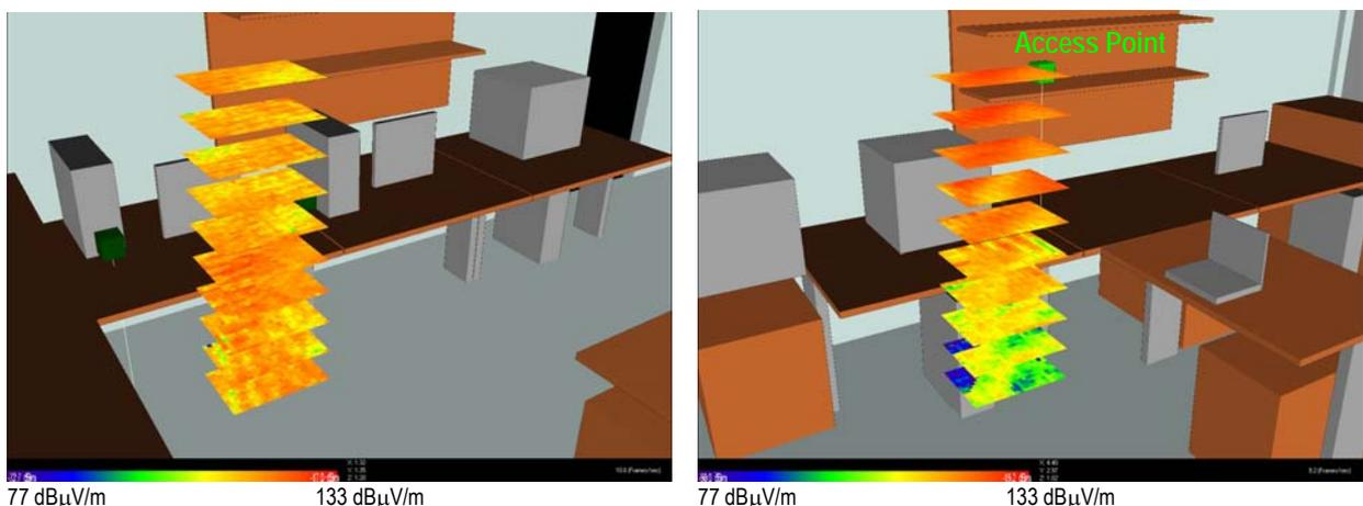
**Abbildung 3.32:** Immissionsbeiträge des Access Points (bei kontinuierlicher Abstrahlung).
