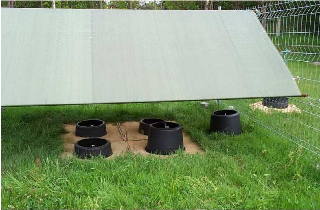
Abbildung 48: Überdachte Testfelder. Die Advektion des Windes auf den Radontransport ist durch unterschiedlich hohe Kunststoffringe eingeschränkt worden.
