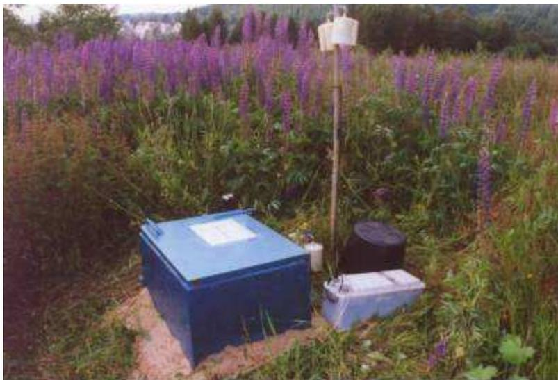
Abbildung 17: Exhalationsmessung auf dem Haldenplateau. Zu erkennen ist auch die Meßeinrichtung des BfS zur Bestimmung der Radonkonzentration in 10 cm und 1,5 m Höhe.
