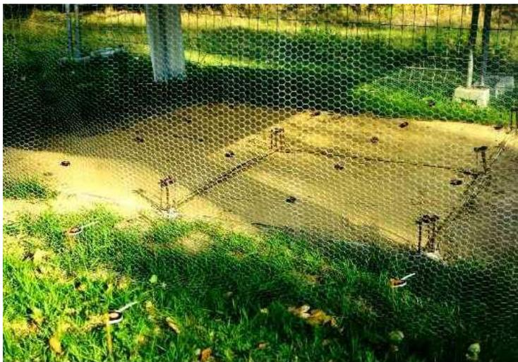
Abbildung 46: Oben: Testfelder zum Einbau vorbereitet, mittig: auf der Wiese eingebaute Testfelder, unten: Testfelder mit jeweils 9 Kernspurdetektoren bestückt, das Netz im Vordergrund ist zum Abweisen von Vögeln
