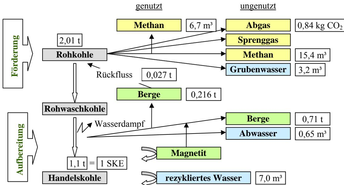
Abbildung 10: Stoffmengenflüsse bei der Steinkohlenförderung und -aufbereitung in Deutschland, 1994, bezogen auf 2,01 t Rohkohle = 1 t<sub>SKE</sub> (Zahlenangaben nach /Hinrichs et al., 1999/)
