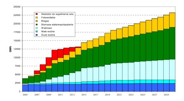
Abb. 2.7 Prognostizierte Elektroenergieerzeugung aus erneuerbarer Energie bis zum Jahr 2030. [ARE S.A. 2007]<sup>20</sup>.
