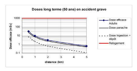
Abb. 3.2 Dosen nach schwerem Ausfall mit geschmolzenem Spaltraum im Reaktor UK EPR<sup>33</sup> (Beschreibung unten).
