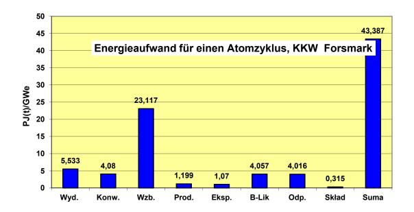
Abb. 12.5 Der Energieaufwand für den Kernbrennstoffkreislauf, Daten laut Deklaration der Umwelteinwirkung für das KKW Forsmark<sup>135</sup>. Abkürzungen in der Abbildung: Wyd. Bergbau und Behandlung von Uran Konw – Konvertierung von UF6, Wzb- Anreicherung, Prod- Produktion von Kraftstoff, Eksp –Betrieb des KKW, B-Lik – Bau und Stilllegung des KKW, Odp – Entsorgung radioaktiver Abfälle, Skład- Deponiebau.
