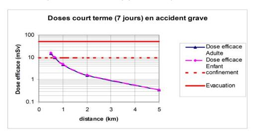
Abb.3.1 Die innerhalb einer Woche nach schwerem Ausfall mit geschmolzenem Spaltraum im Reaktor EPR bekommenen Dosen – Beschreibung im Nachfolgenden.
