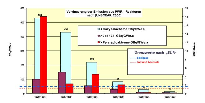
Bild. 16.1 Verringerung der Emission aus PWR – Reaktoren , Zahlen nach dem Bericht von UNSCEAR <sup>200</sup> [bestimmte Emissionen in TBq (für Edelgase ) und GBq (für Jod und Stäube) pro Einheit der hergestellten Elektrizität im Jahr bei der Dauerleistung von 1000 MWe.]
