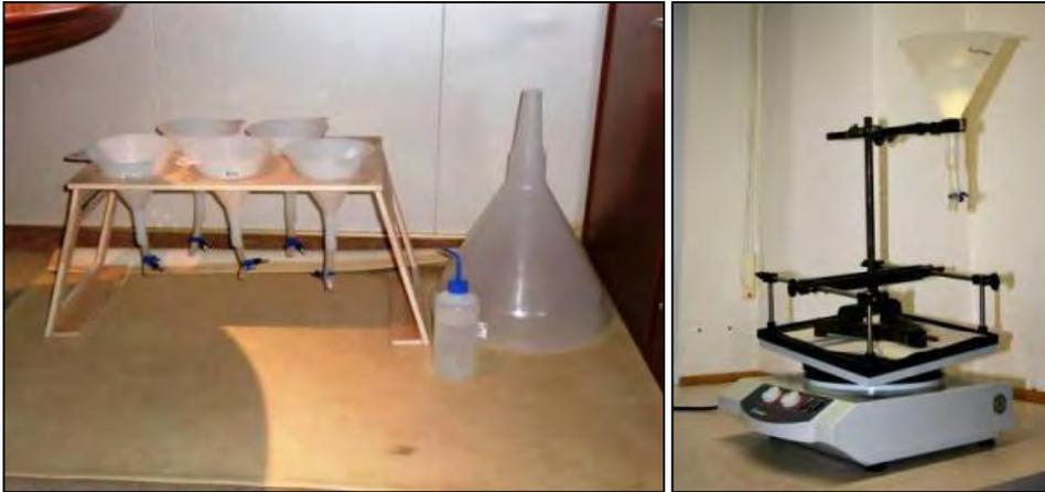
**Abb. 21:** Links: Reise-Baermann-Anlage zum Absetzen von Bodenorganismen in den Effizienzproben. Rechts: Anlage der Vorversuche
