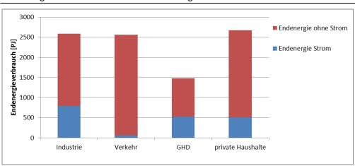
Abbildung 22: Anteil Strom am Endenergieverbrauch der Sektoren in PJ für Deutschland in 2010
