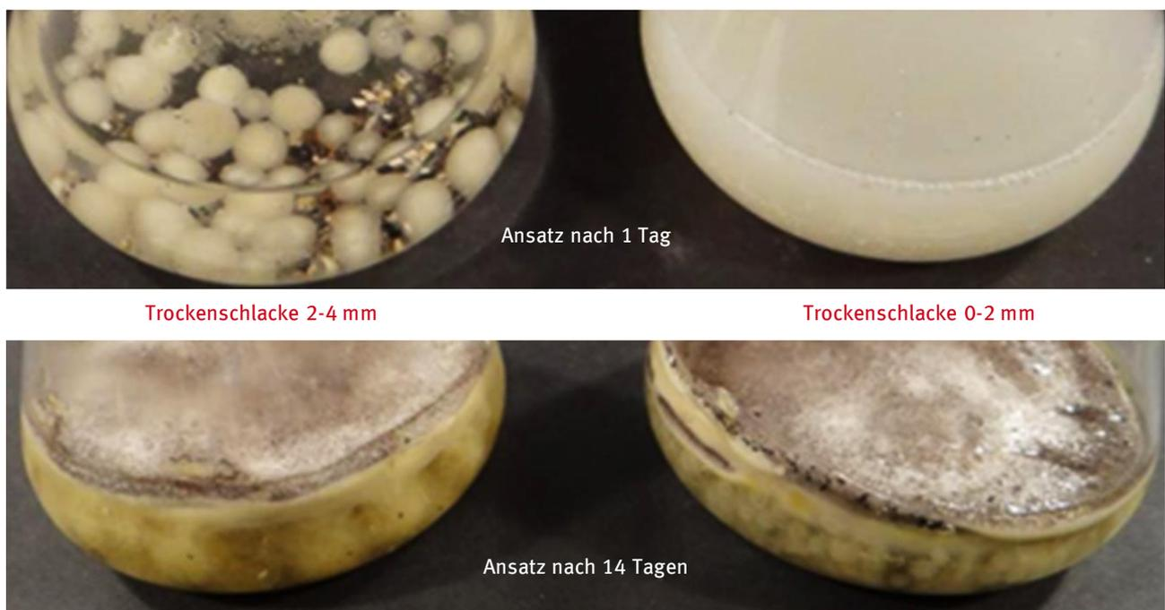
Bei Behandlung der Kornklasse 2-4 mm kam es anfänglich zu einem verzögerten Wachstum. Nach einigen Tagen war jedoch kein Unterschied zum Ansatz mit der Kornfraktion 0-2 mm mehr erkennbar. Nach 14 Tagen hatte der Pilz den Kolben vollständig ausgefüllt.
