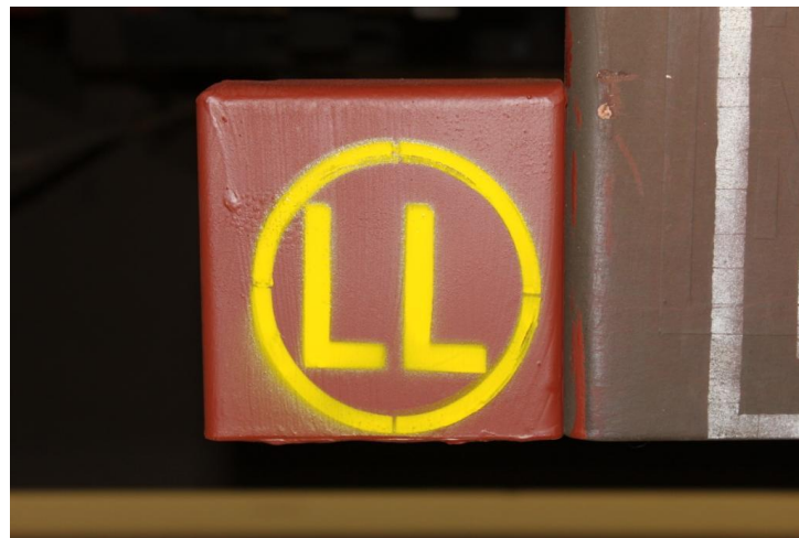
Bild 5: Kennzeichnung eines auf LL-Sohlen umgerüsteten Güterwagens. Präsentation der Sohlen durch DB, BMVBS, UIC am 4.06.2013 in Berlin (Foto: M. Jäcker)
