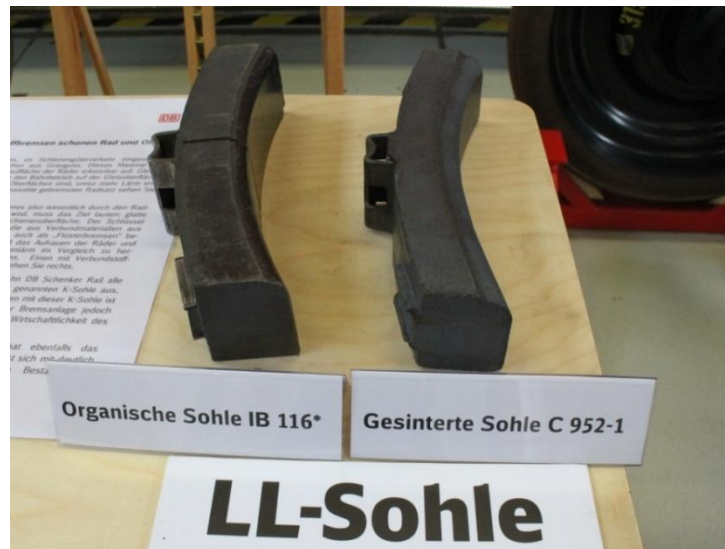
Bild 4: Zugelassene LL-Sohlen : Präsentation der Sohlen durch DB, BMVBS, UIC am 4.06.2013 in Berlin (Foto: M. Jäcker)
